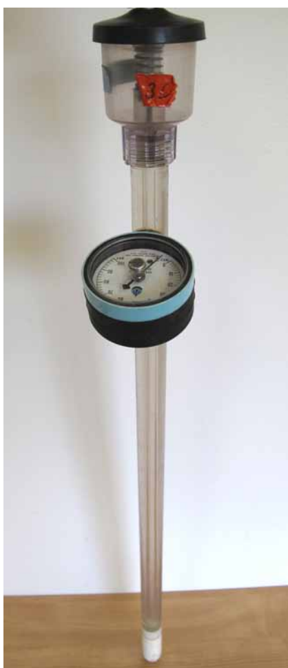
FIGURE 9. TENSIOMÈTRE AVEC EMBOUT EN CÉRAMIQUE
