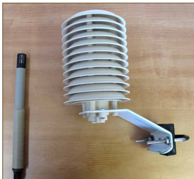
FIGURE 6. SONDE DE MESURE DE LA TEMPÉRATURE ET DE L'HUMIDITÉ RELATIVE DE L'AIR (RETIRÉE DE SON ABRI)
